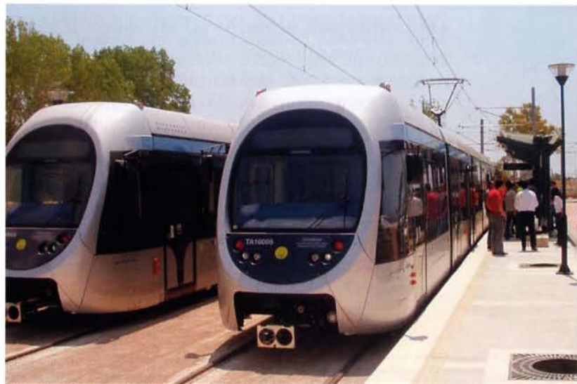
5: Le nouveau tram d'Athènes, à air conditionné et plancher bas.
